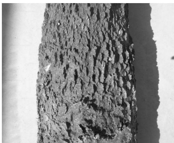
Figura 3. Superficie laterale di un micropalo in resina armata.
