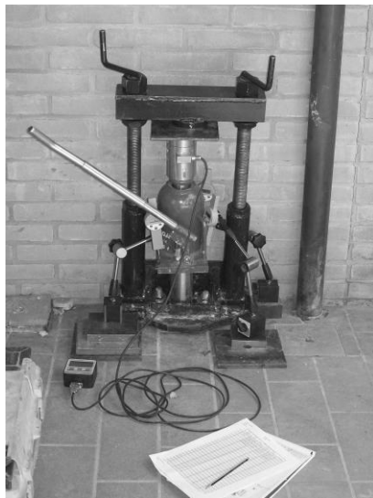
Figura 9. Sistema di contrasto per l'esecuzione delle prove di carico in presenza di fondazione superficiale.
