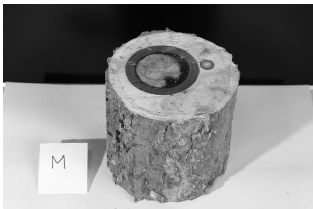
Figura 2. Sezione di un micropalo in resina armata.
