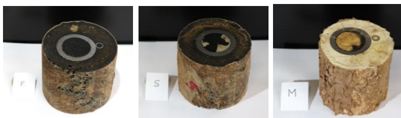
Figura 4. Sezione orizzontale dei tre micropali testati.
