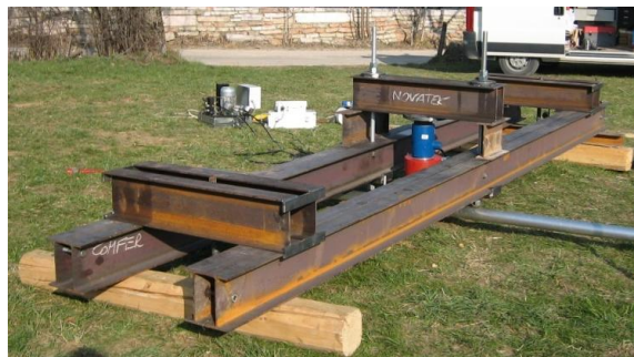
Figura 3. Struttura di contrasto per le prove di carico in sito.
