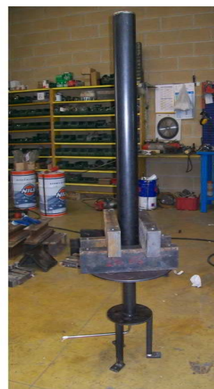
Figura 1. Pistone HDR per confezionamento dei provini con espansione confinata.
